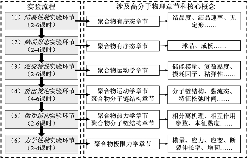
图 1 聚丙烯挤出发泡综合实验主要流程图
